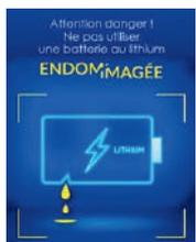
Face à une batterie endommagée, il est important de la repérer, de l'isoler, et de stopper immédiatement sa charge. Ne la jetez pas à la poubelle : placez-la dans un sachet plastique, puis dans un bac incombustible avec un matériau inerte (sable, vermiculite). Stockez-la dans un endroit ventilé, loin des autres batteries et des matériaux combustibles, de préférence à l'extérieur. Faites appel à une entreprise spécialisée pour son évacuation si possible.
